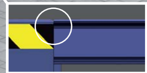
Stufenloser Übergang bei voll ausgefahretem Vorschub
